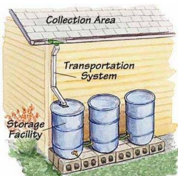
Rajah 2 : Tiga Komponen Asas SPAH Bangunan
